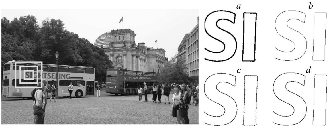
Рис. 1. Слева — исходное изображение, справа: a — первичные контуры; b — сильно утонченные контуры, имеющие лишние разрывы; c — слабо утонченные контуры, содержащие ложные отростки; d — окончательные контуры после процедуры утончения
